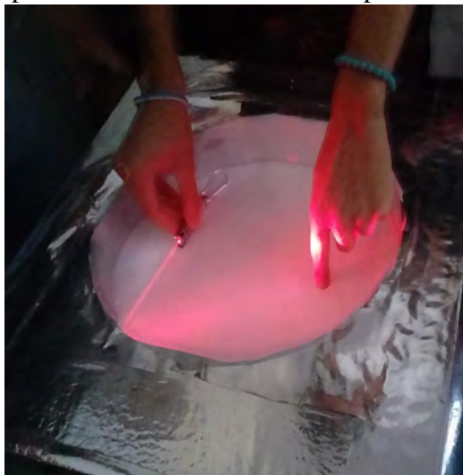
Figura 8.13: Experimento de reflexão numa superfície refletora elíptica
